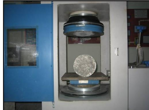
**Uji Belah Silinder Beton
