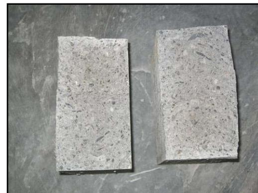
**Benda Uji Silinder setelah Uji Belah**
